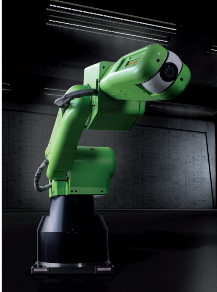
La solution de Fanuc pour la cobotique : un robot traditionnel équipé d'un détecteur de choc à sa base et recouvert d'une mousse amortissante. Avantage : il offre une capacité de charge de 35 kg.
