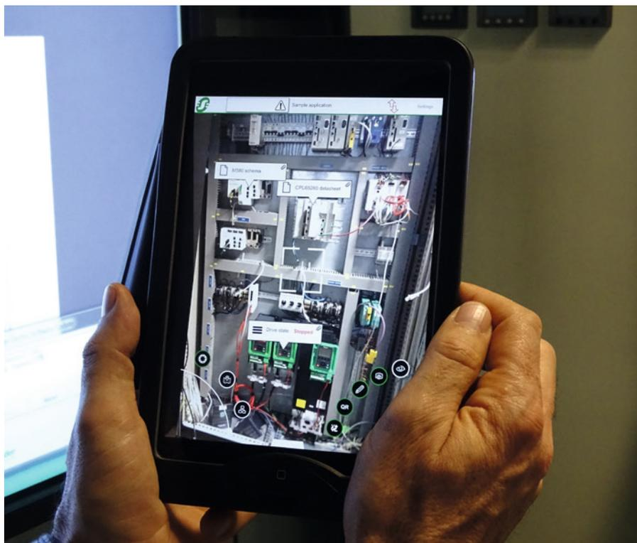
va identifier le matériel par reconnaissance optique et superposer sur l'image, tous les points d'intérêt qui lui correspondent. L'application étant reliée en temps réel aux sources de données, les alarmes et les valeurs des grandeurs mesurées sont immédiatement accessibles à l'opérateur. L'application peut aussi donner accès à des informations complémentaires comme des documents recelant des conseils d'intervention, des mises en garde de sécurité, des plans, des schémas, etc.
